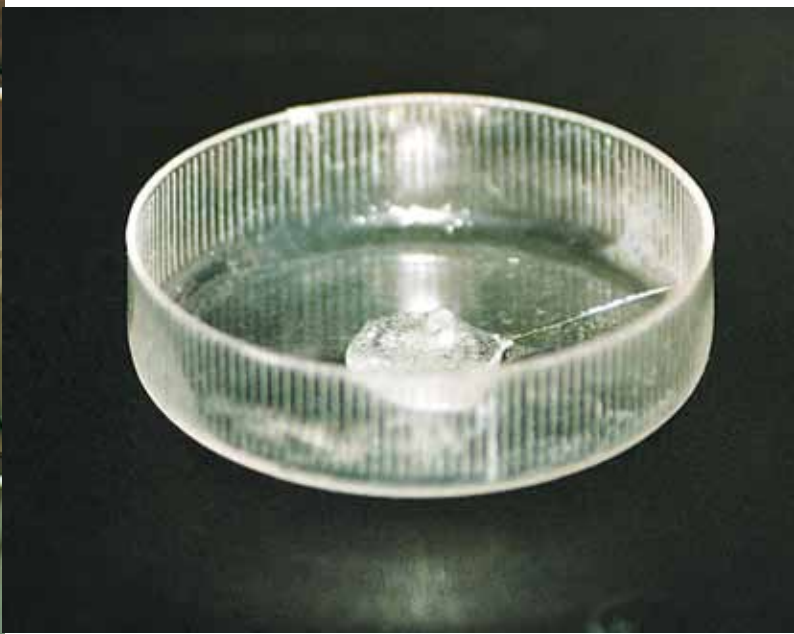
Mit einer Pipette wird ein zu testender Wassertropfen auf die Petrischale aufgebracht
